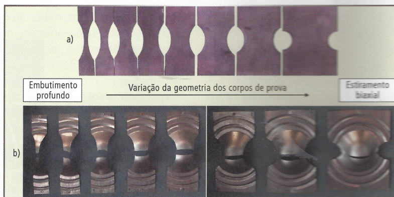
Fig. 11 - Corpos de prova para o ensaio Nakajima: a) antes do ensaio; e b) ruptura dos corpos de prova após o ensaio (Fonte: LdTM).
