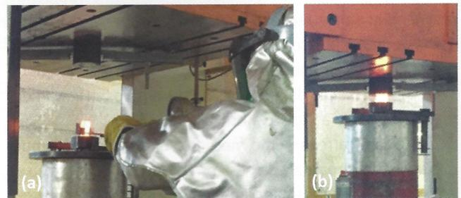
Figura 5 - Forjamento Experimental. (a) Posicionamento no billet (b) Forjamento
