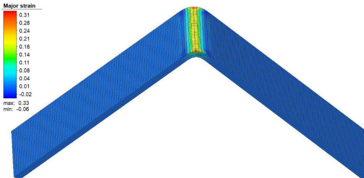
Figura 9: Simulação numérica computacional da Deformação Verdadeira ( \varphi_x ) do aço S700MC para Raio do punção ( r_p ) de 3mm.
