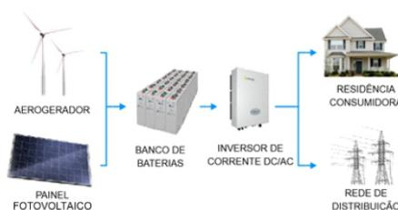
Figura 1 – Associação de baterias em sistemas de geração de energia eólica e solar.
